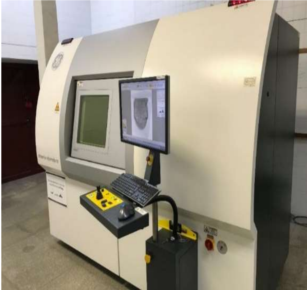
Figura 10 - Microtomógrafo, PhoenixV|tome|x M (Waygate Technologies), da General Electric, com sua mesa de controle para telemanipulação de partes internas do conjunto do sistema de MicroCT.
