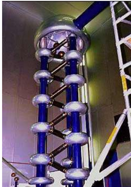
Fig. A.2. Acelerador de Cockroft-Walton instalado no FERMILAB.
