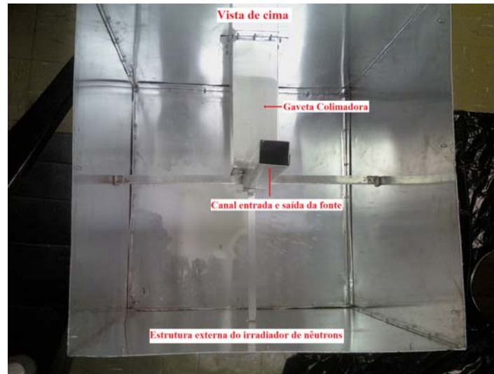
Figura III.24 – Estrutura do Irradiador de nêutrons: vista panorâmica superior da caixa de alumínio.
