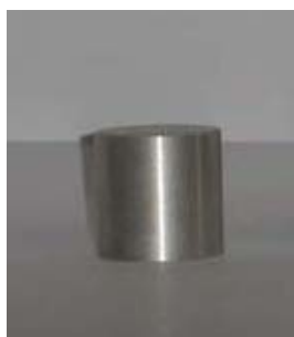
Figura III.2 - Fonte encapsulada de ^{241}\text{Am-Be} utilizada no irradiador de nêutrons.
