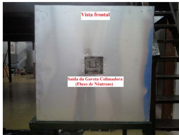
Figura III.25 – Estrutura do Irradiador de nêutrons: vista frontal da caixa de alumínio.
