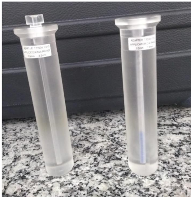
Figura 3. 13- inserto para posicionamento da fonte é feito de material PMMA
