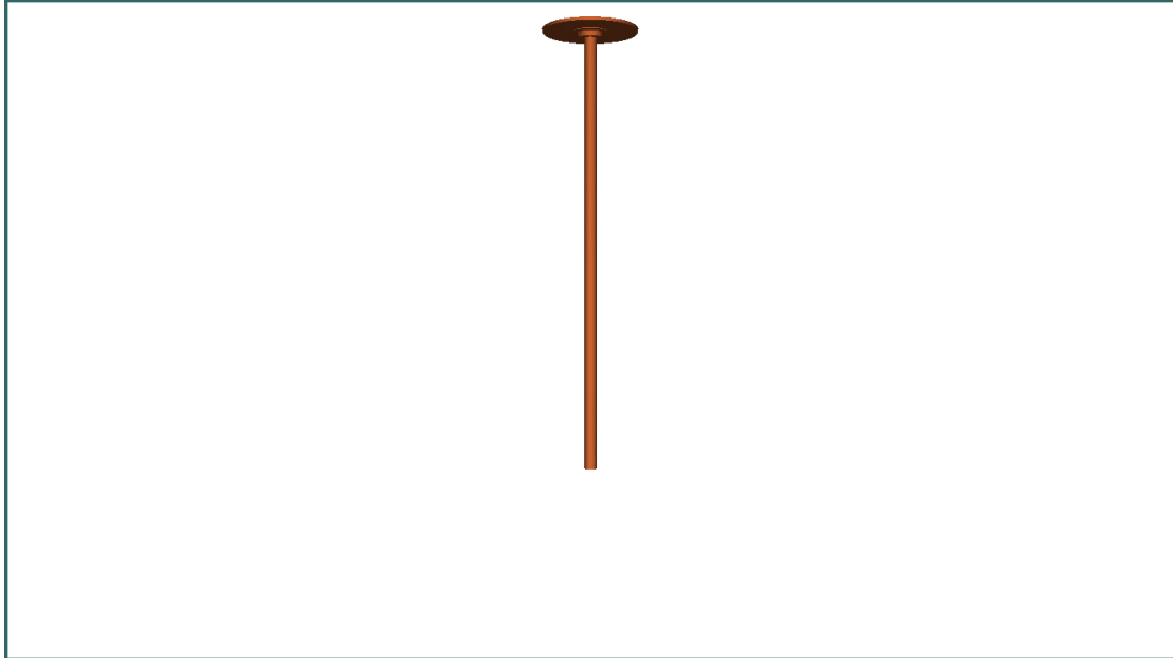
Figura 3. 15- inserto parte interna, foi construído um cilindro interno de ar, por onde passara o cateter 3D.
