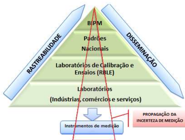
Figura 1. Fluxo hierárquico do sistema metrológico (Fonte http://www.calibracaoceime.com.br/2013/02/artigos-tecnicos-rastreabilidade/ ).
