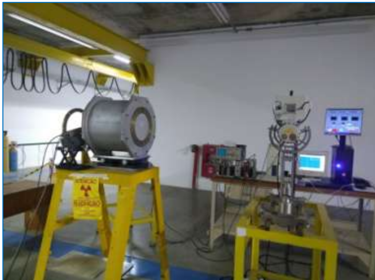
Figura 27. Medições com o LC para padronização do campo de radiação do gerador de nêutrons no IEAv.
