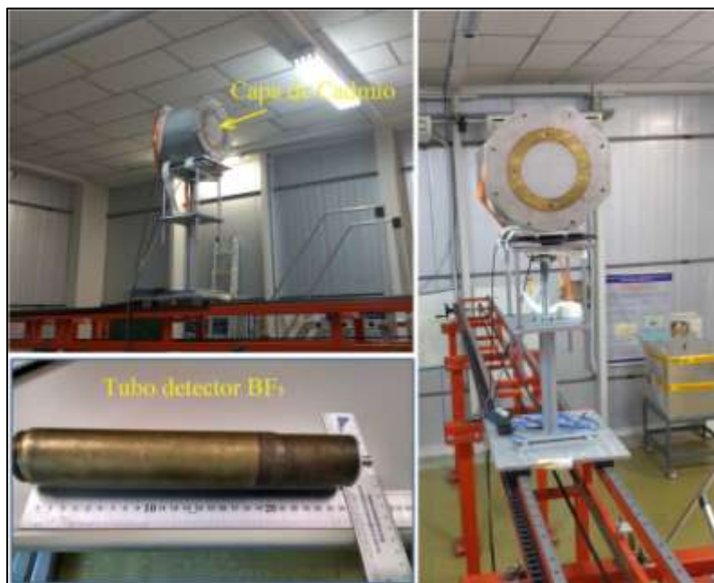
Figura 17. Vista lateral, frontal do LC no LBE do LN e tubo detector BF_3 .
