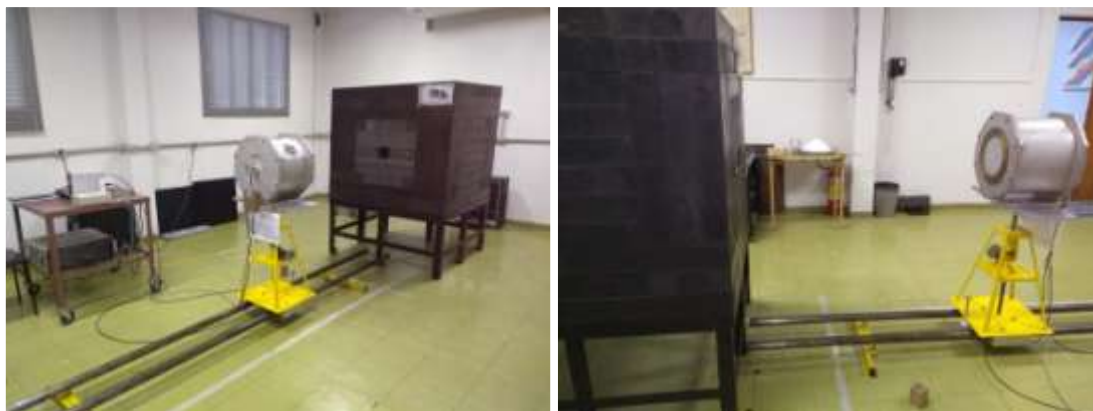
Figura 23. Medição com o LC nas instalações da unidade padrão de fluxo de nêutrons térmicos, FT2, do LNMRI/IRD.
