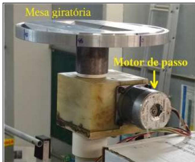
Figura 19. Sistema automatizado de rotação de fonte para avaliação de anisotropia.
