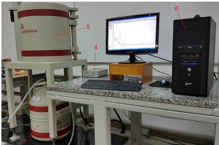
Figura 2.26 Sistema de detecção gama com HPGe
