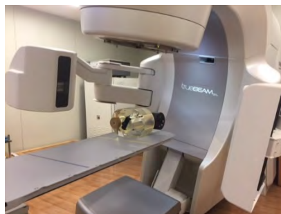
Figura 18: Posicionamento do Quasar na mesa do acelerador linear Truebeam.
