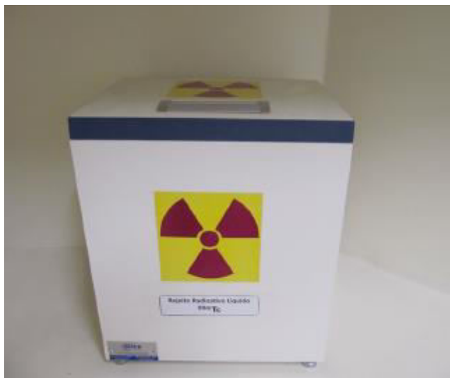
Figura 2.10 – Caixa blindada para armazenamento temporário de rejeitos sólidos contendo ^{99m}\text{Tc} (GARCEZ, DA SILVA & PAES, 2011).
