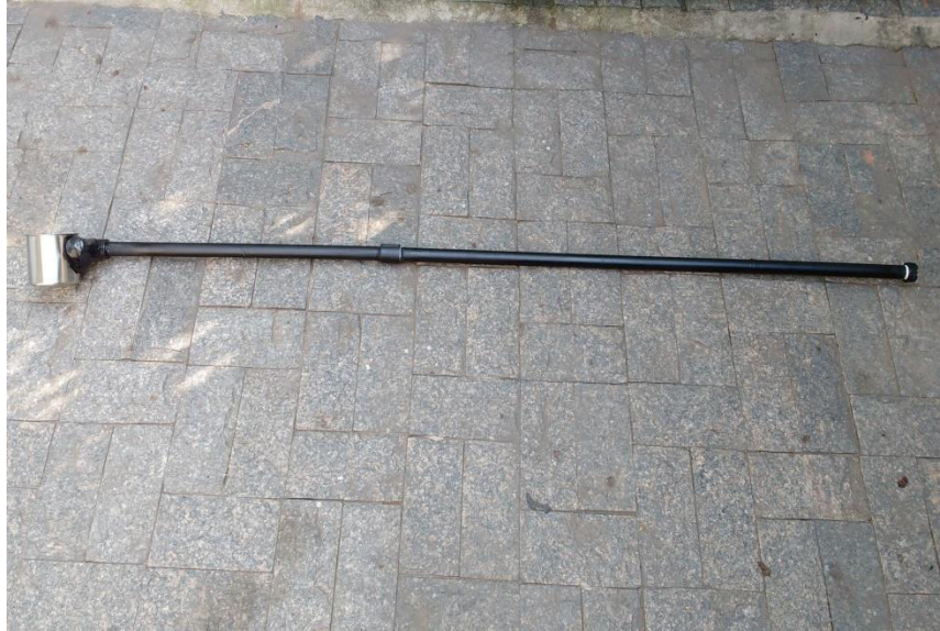
Figura 3.2 – Coletor de amostras de esgoto.
