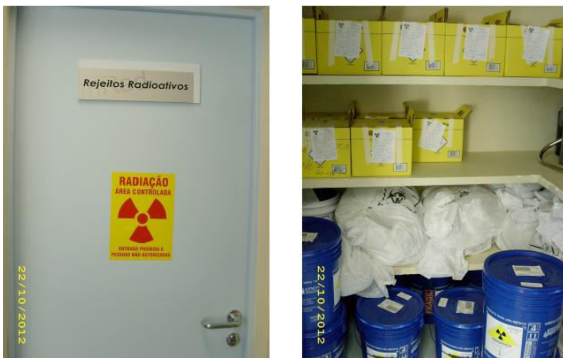
Figura 2.9 – Depósito para armazenamento temporário de rejeitos contendo radionuclídeos de um Serviço de Medicina Nuclear: seringas e acessórios usados na injeção de radiofármacos acondicionados em caixas amarelas com etiqueta de identificação com símbolo internacional de radiação ionizante, separados dos geradores de ^{99}\text{Mo} - ^{99\text{m}}\text{Tc} e de rejeitos biológicos (GARCEZ, DA SILVA & PAES, 2011).
