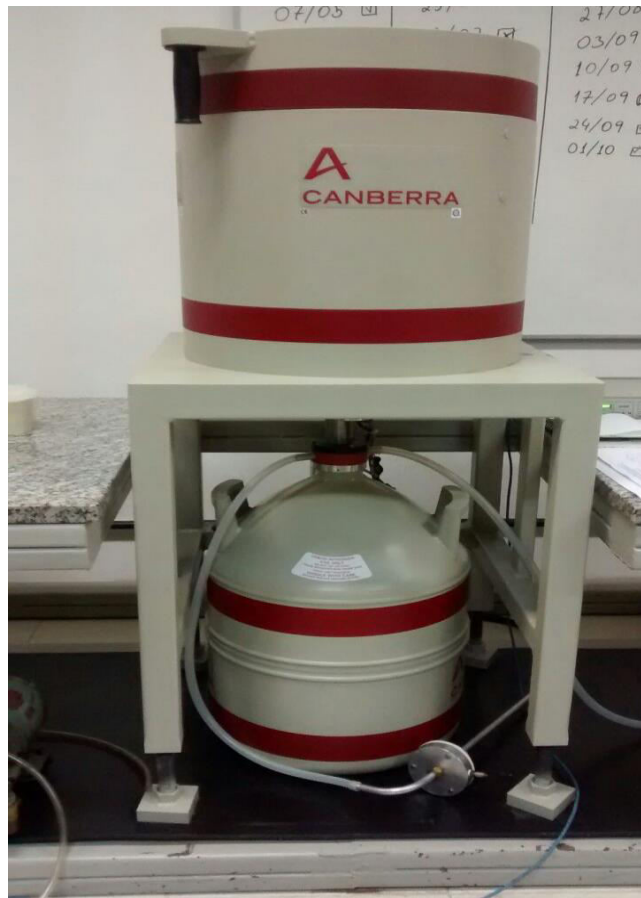
Figura 3.7 – Detector de HPGe com blindagem da marca Canberra, modelo GC3020.
