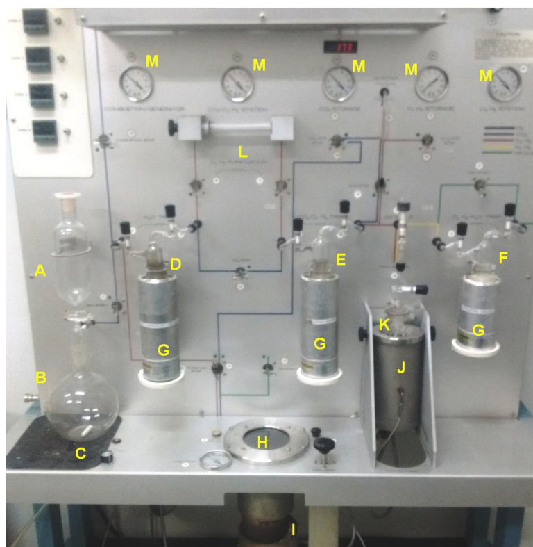
Figura 3.9 Linha da síntese benzênica ( TASK benzene synthesizer , Athens, Georgia, EUA) do Laboratório de ^{14}\text{C} do Instituto de Radioproteção e Dosimetria.
