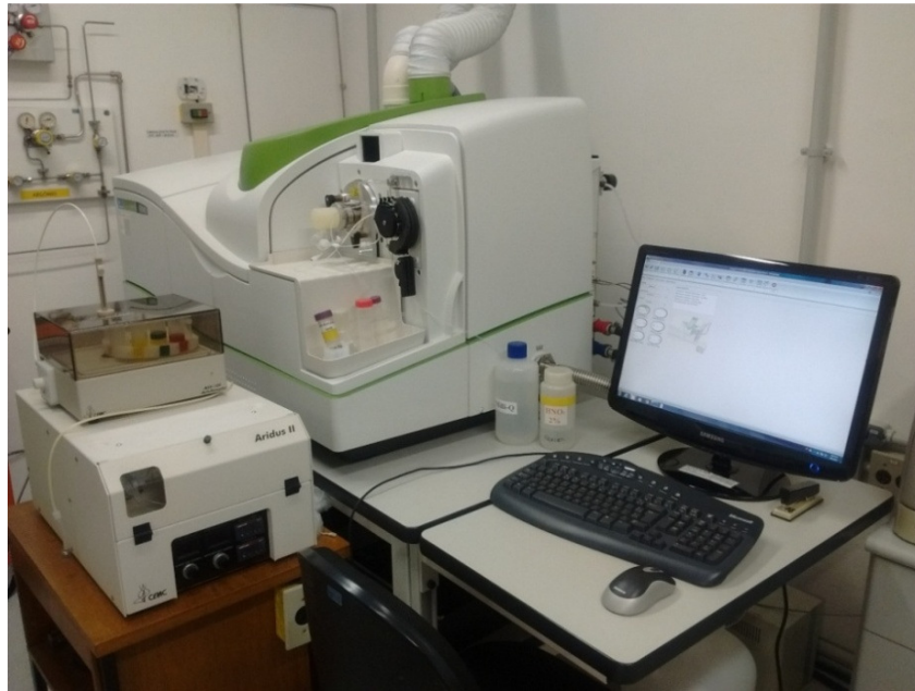
Figura 3.24 Equipamento de Espectrometria de Massa com Plasma Indutivamente Acoplado (ICP-MS) do Laboratório de Espectrometria de Massas - IRD
