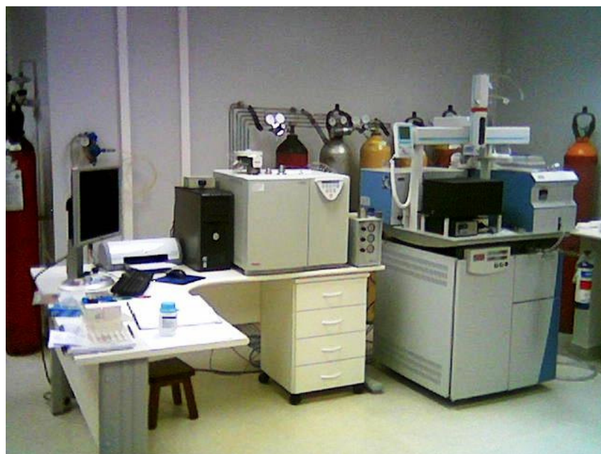
Figura 3.23 Espectrômetro de massa de razões isotópicas Delta V Plus acoplado a um sistema Gás Bench II – Laboratório de Isótopos Estáveis- Universidade de Brasília.
