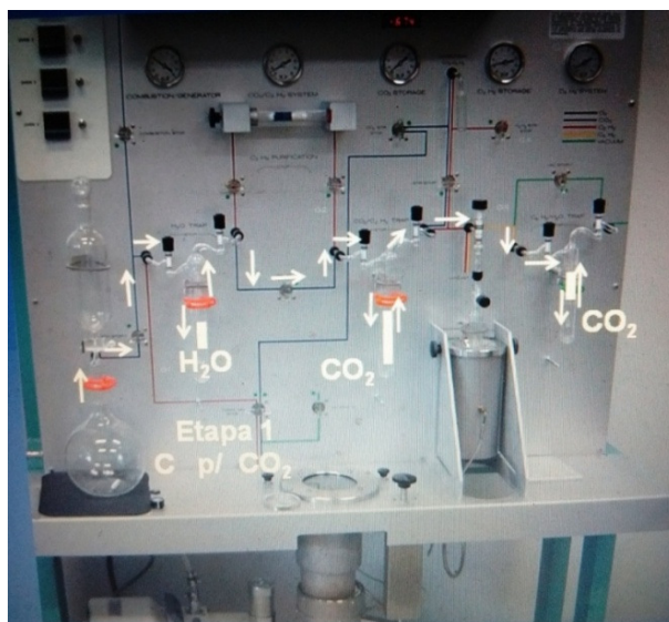
Figura 3.13 Esquema da Produção e recolhimento do gás carbônico. O primeiro tubo, da esquerda para a direita, fica acondicionado num dewar contendo álcool isopropílico e gelo seco e os demais, acondicionados em dewar contendo nitrogênio líquido.
