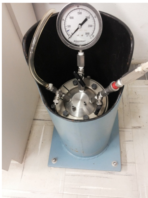
Figura 3.11 Bomba Parr dentro do sistema de proteção.
