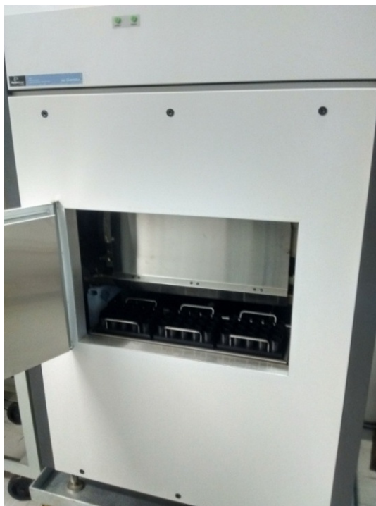
Figura 3.22 Instrumento de cintilação em meio líquido Perkin Elmer Quantulus 1220.
