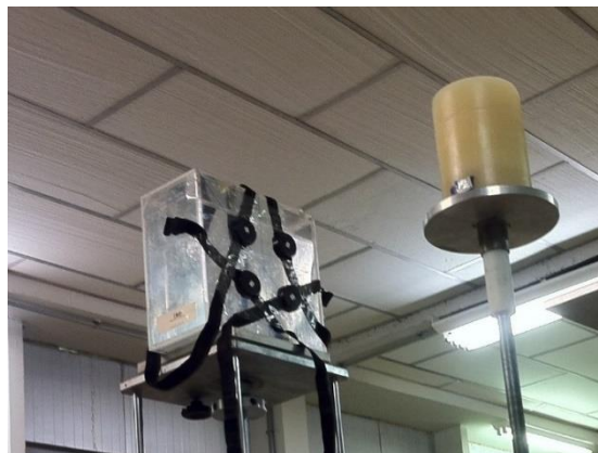
Figura 34: Arranjo experimental da irradiação dos albedos do IRD em espectro de ^{241}\text{Am-Be} moderado por parafina.
