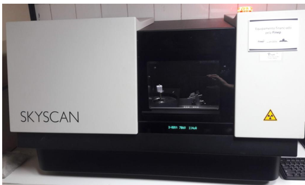
Figura 4 - Foto do equipamento de microtomografia SkyScan/Brucker modelo 1173.
