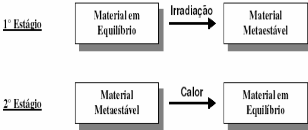
Figura 2.14: Representação esquemática dos dois estágios de qualquer processo termicamente estimulado, como a termoluminescência (MAURÍCIO, 2001).
