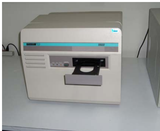
Figura 3.5: Leitora HARSHAW 5500 – Departamento de Física Médica - IRD
