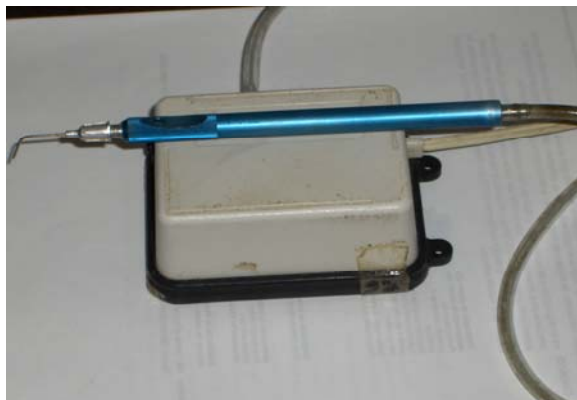
Figura 3.2: Pinça a vácuo para manipulação dos TLDs
