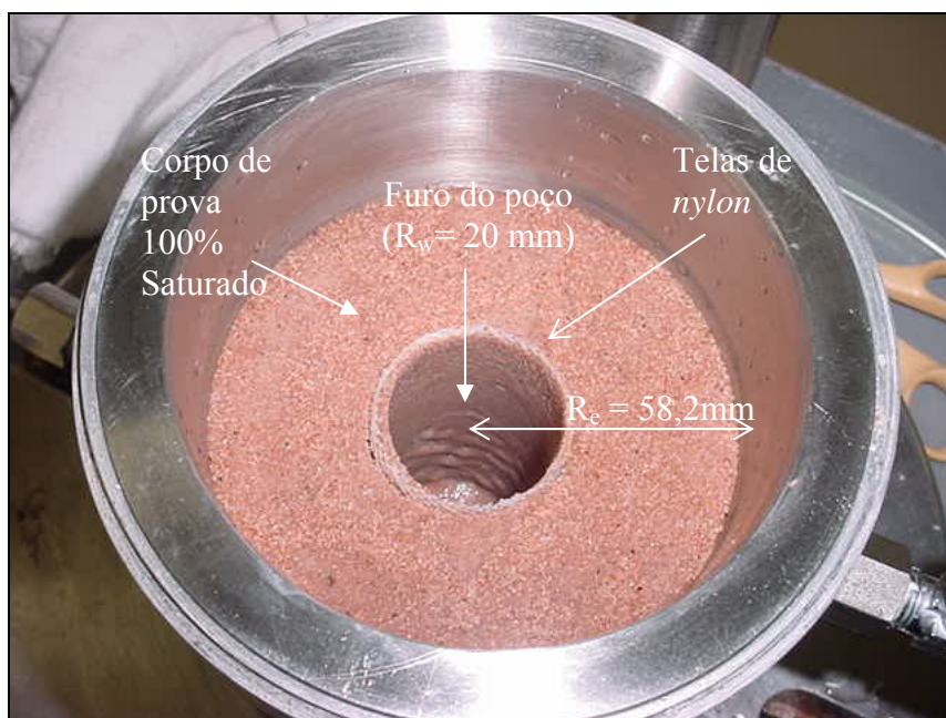
Figura 4.17: Corpo de prova saturado e compactado.
