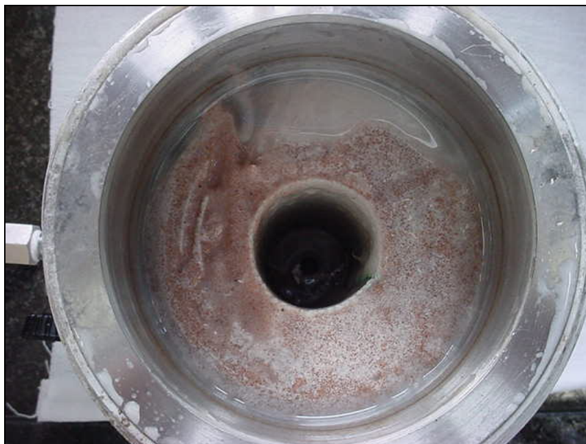
Figura 4.21: Corpo de prova após ensaio de dano.
