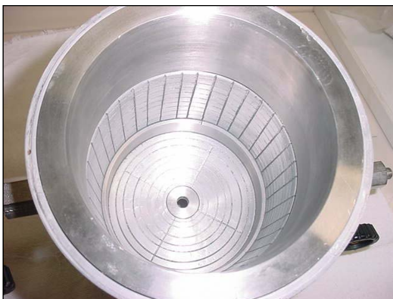
Figura 4.2: Célula de interação rocha fluido para arenitos inconsolidados.
