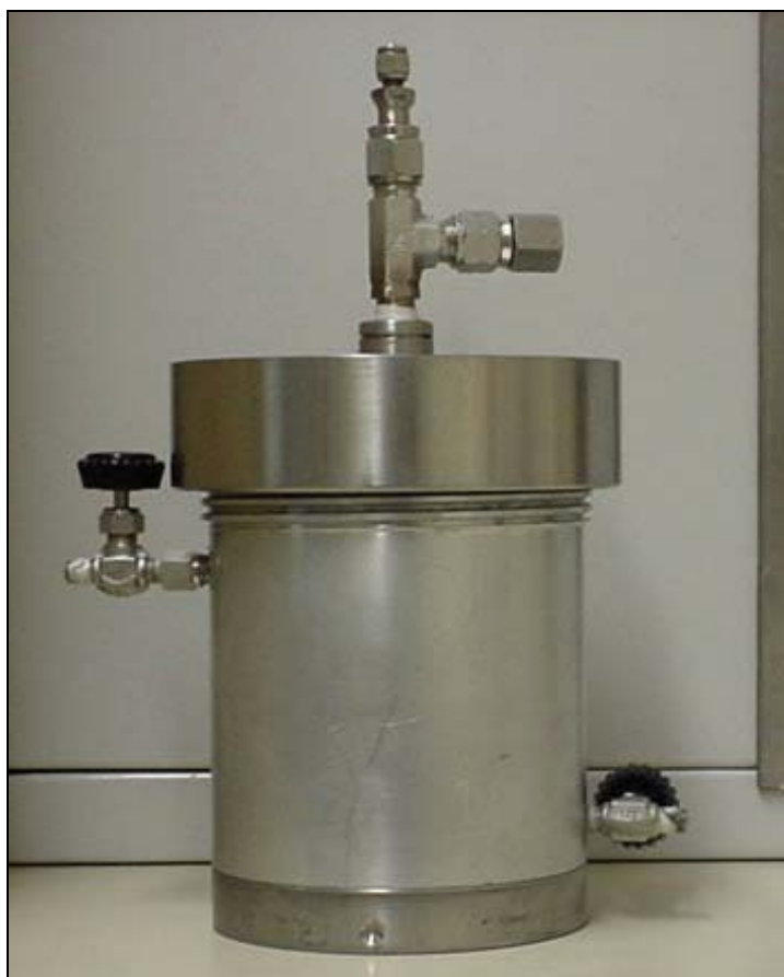
Figura 4.2: Célula de interação rocha fluido para arenitos inconsolidados.
