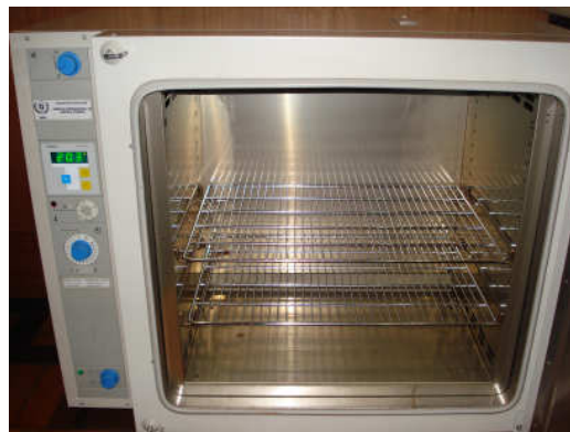
Figura 3.2 Estufa Heraeus utilizada para fazer a secagem
