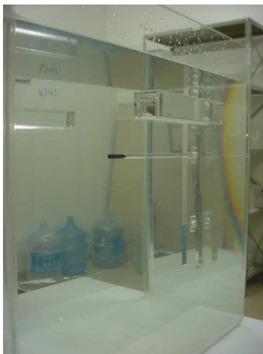
Figura 3.11 Dosímetro TL de calibração fixado no sistema suporte-braço no fantoma na água (VIAMONTE, 2003).
