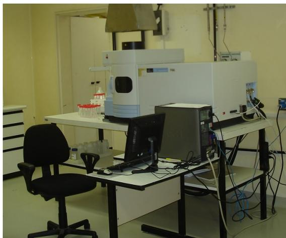
Figura 4.8: ICP-OES Optima 2100 com amostrador automático AS-93 Plus (Perkin Elmer).
