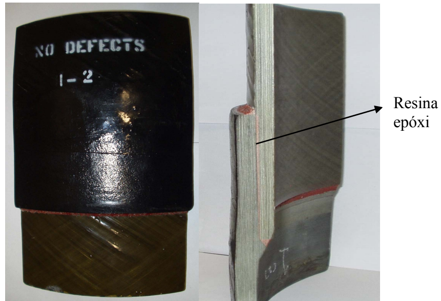
Figura III.1- Peça cortada de um duto compósito sem defeito em sua junção - visão frontal (superfície) e visão lateral (profundidade).
