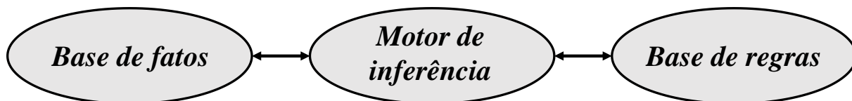
Figura 3.2 – Interconexão dos componentes de um sistema especialista.
