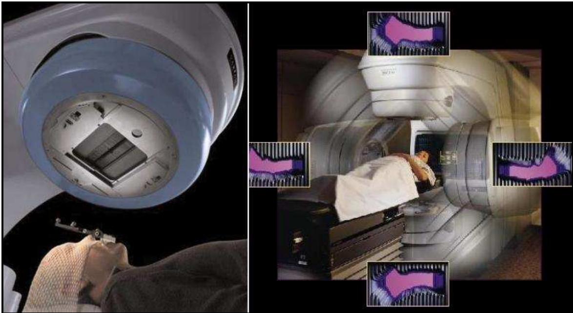
Figura 2.4 – Duas imagens apresentando o MLC sendo utilizado num tratamento convencional de radioterapia. Na imagem da direita pode-se observar o MLC formando quatro campos distintos, um para cada posição do gantry do equipamento. (fonte: Varian Medical Systems)
