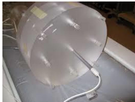
Figura 19: Simulador de tronco com detector tipo lápis inserido em seu orifício central
