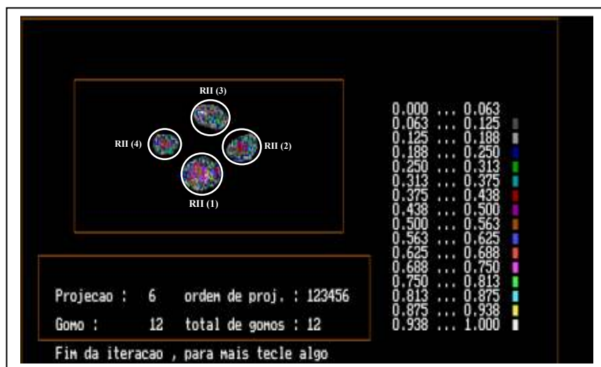
Figura III.24. Imagem tomográfica de um objeto contendo quatro materiais, e suas respectivas RII
