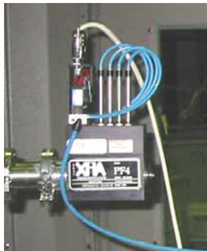
Figura III-10 – Módulo de filtros eletro-pneumático
