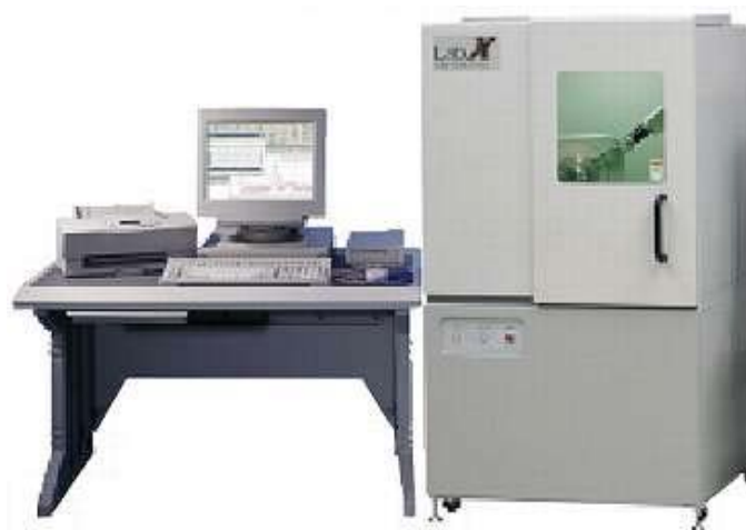
Figura III-8 – Difratoômetro XRD-6000 - Unidade principal e sistema de processamento de dados.
