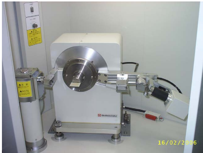
Figura III-9 – Vista interna da unidade principal do difratômetro XRD-6000.
