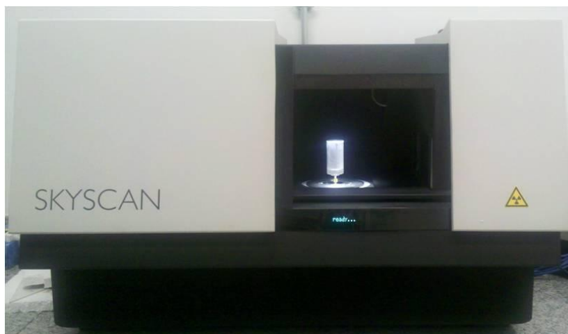
Figura IV. 11: Foto do equipamento de microCT Skyscan/Bruker modelo 1173.
