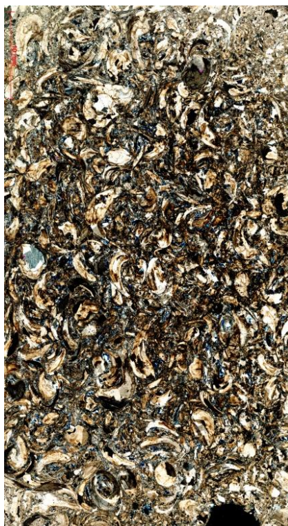
Figura V. 35: Fotomicrografia da lâmina petrográfica da amostra 05, nota-se que a composição é composta praticamente por bivalves parcialmente fragmentados e raramente articulados.
