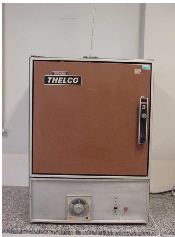
Figura 5.6: Visualização da estufa durante realização do teste “Estabilidade sob Diferentes Condições Climáticas - Armazenamento por 7 Dias: Umidade Padrão e Temperatura Ambiente = 50^{\circ}\text{C} \pm 5^{\circ}\text{C} ” (4.3.3c) do IRD
