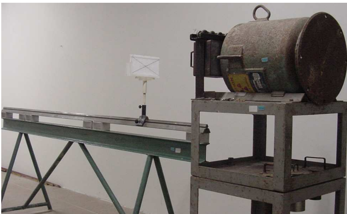
Figura 4.2: Arranjo experimental de irradiação do Porta-TLDs no irradiador de ^{60}\text{Co} do LABIR
