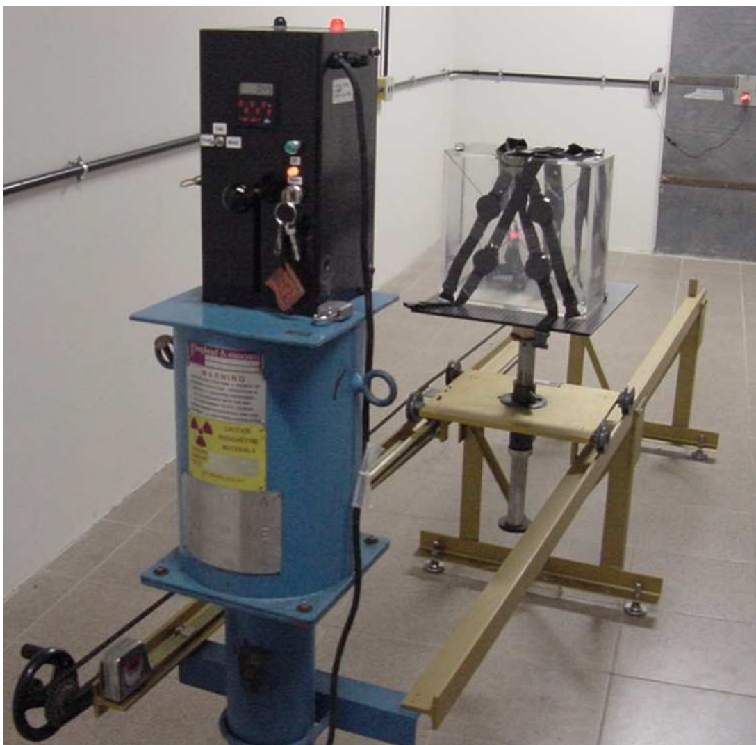
Figura 5.3: Visualização do arranjo experimental de irradiação com fonte ^{137}\text{Cs} (quatro monitores por simulador) no LABIR/IRD
