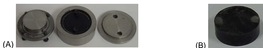
Figura 4.6: BNI: (A) após o desmolde da fôrma e (B) após o polimento das rebarbas
