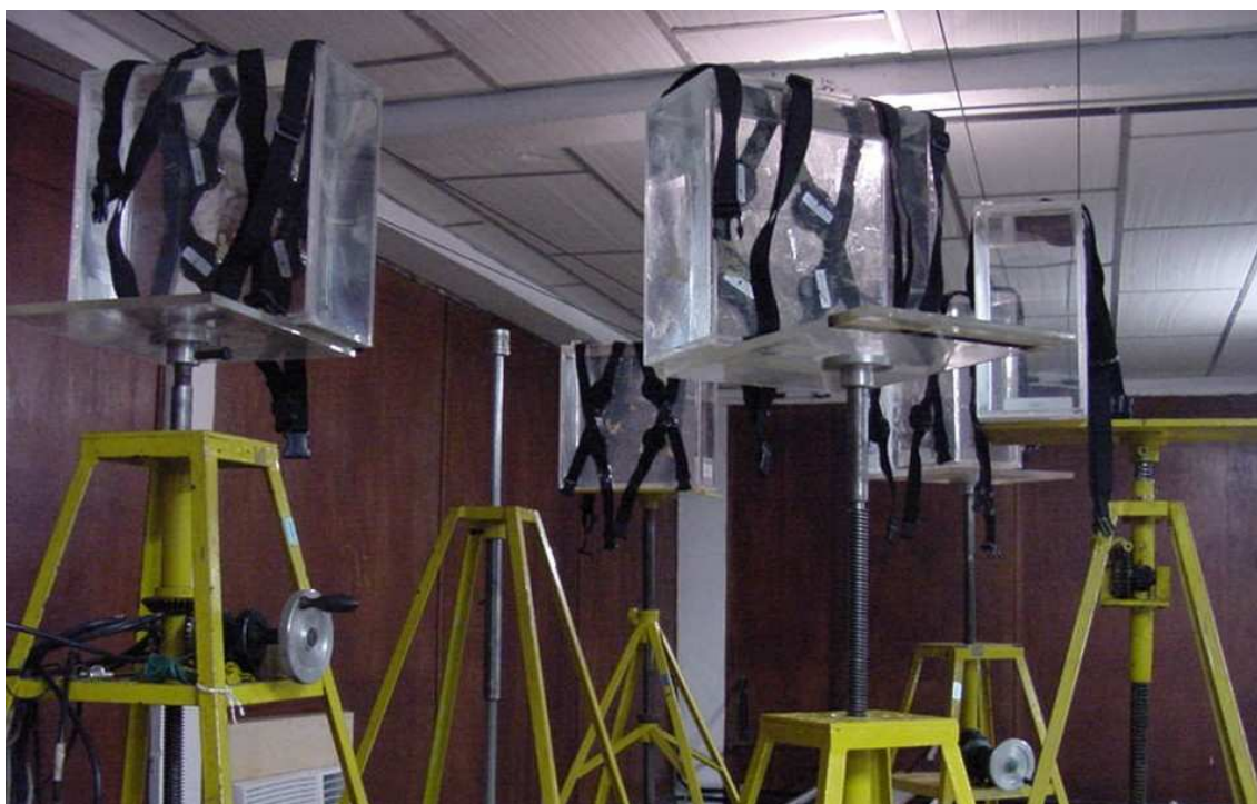
Figura 5.4: Arranjo experimental de irradiação simultânea com fonte de nêutrons de cinco simuladores (quatro monitores por simulador) no SBE do LN/IRD
