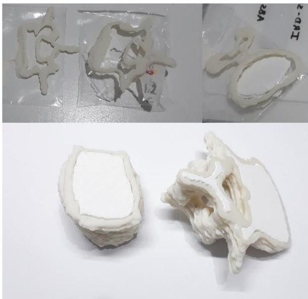
**Figura 21.** A região bege representa o osso cortical e a branca o a região trabecular (osso e medula óssea). Na parte superior estão as fatias impressas e na parte inferior são todas essas fatias com as partes cortical e trabecular encaixadas e em seguida empilhadas.
