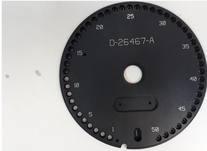
**Figura 26.** Disco usado para inserir os TLDs na leitora. Alguns TLDs podem ser vistos dentro do disco e à esquerda.
