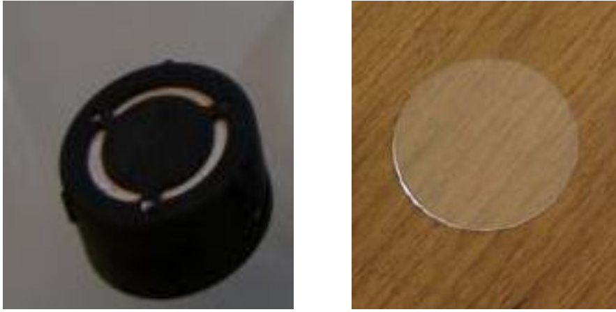
Figura 3.8 - Câmara de difusão e detector Lexan antes da exposição.
