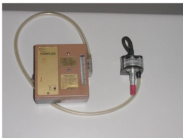
Figura 3.10 - (a) e (b) Fotografias mostrando o amostrador portátil com ciclone para coleta de partículas na fração fina do aerossol.
