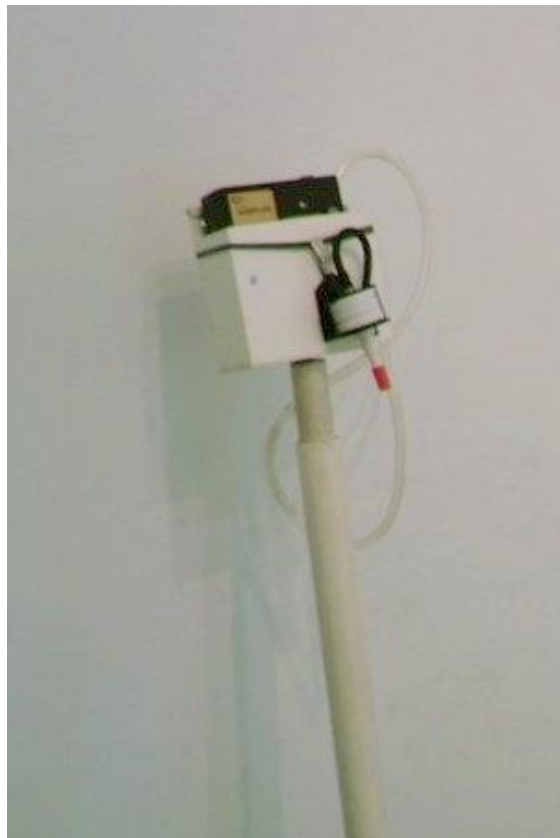
Figura 3.11 - Arranjo experimental do amostrador portátil com ciclone.
