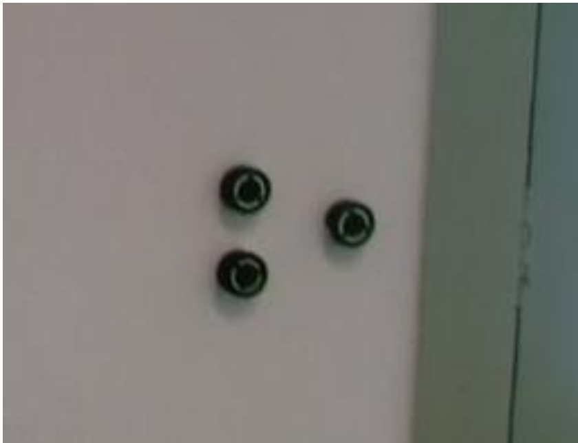
Figura 3.9- Arranjo experimental dos amostradores de radônio.
