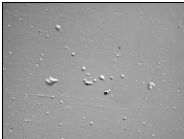
Figura IV.18 – Imagem neutronográfica de uma lâmina de CR-39, sem depósito de MNT, dopada com boro.
