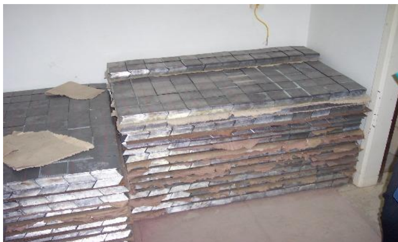
Figura 1.2 – Ilustração da blindagem extra de chumbo para a adaptação de uma sala de radioterapia de uma instituição brasileira.
