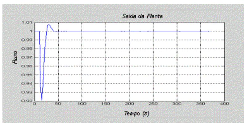
Figura 4.13 - Saída da planta sob ação do controlador
