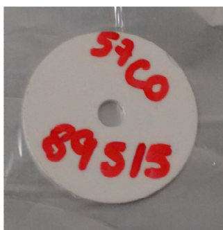
Figura 4.3 – Fonte de PVC de ^{57}\text{Co}
