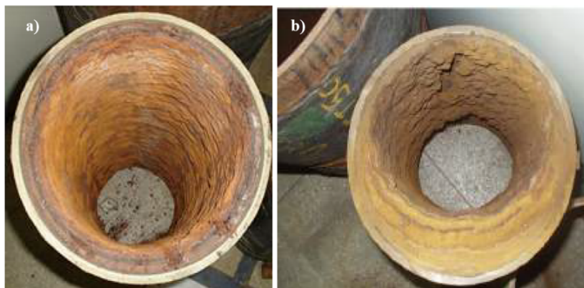
Figura 10- Incrustações em tubulações descomissionadas com formação do tipo concêntrica (a) e excêntrica (b) - (LIN-UFRJ).
