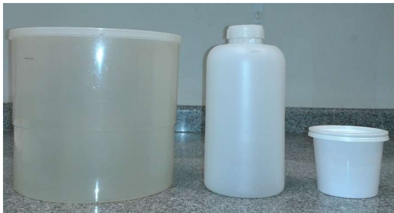
Figura 46: Exemplos de geometria de medição para o sistema de espectrometria gama
