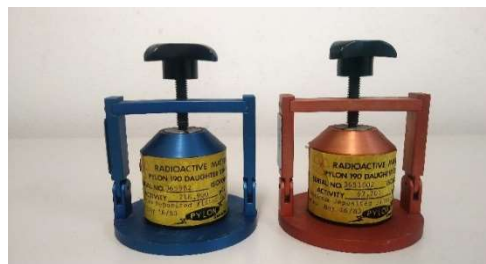
Figura 37: PYLON 190 Padrão para filhos ( ^{226}\text{Ra} e ^{228}\text{Th} )
