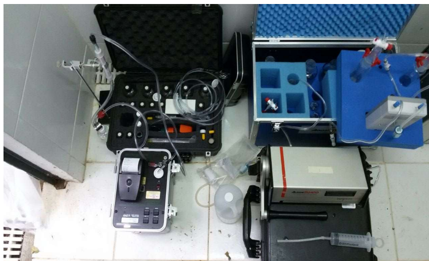
Figura 24: RAD 7 e AlphaGUARD sendo utilizados para coleta e medição de radônio em água
