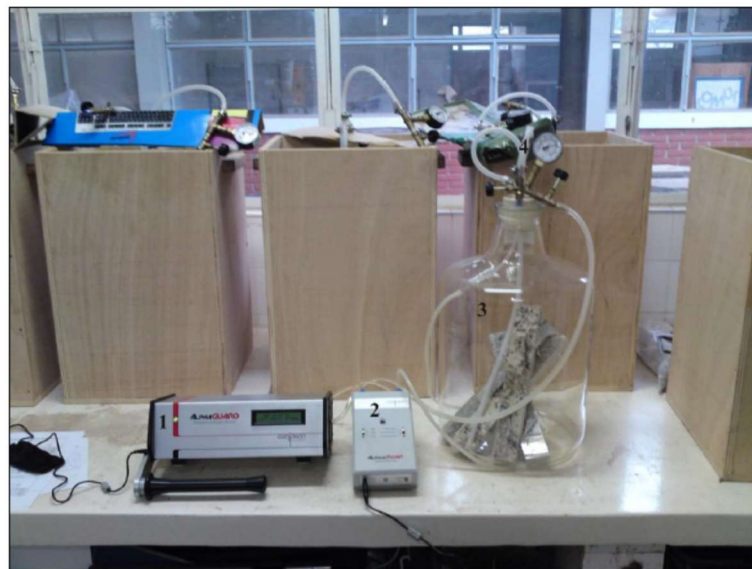
Figura 27: Sistema composto de AlphaGUARD, bomba de ar e garrafão (câmara) contendo as rochas
