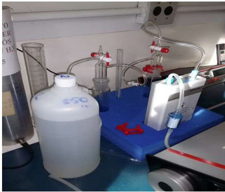
Figura 25: Dispositivo para borbulhar e emanar o radônio
