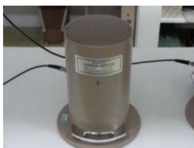
Figura 31: Sistema para determinação alfa total: MS-2 e RD14 e SAC4
