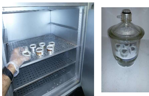
Figura 21: Detectores passivos de carvão na estufa, selados e transferidos para o dissecador
