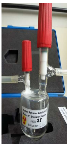
Figura 36: Material de referência ^{222}\text{Rn} (padrão de emissão)
