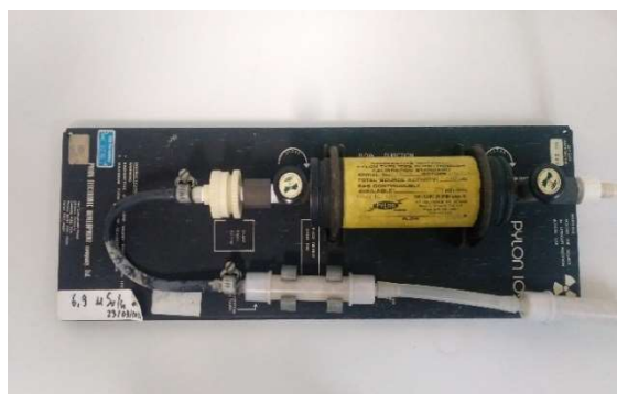
Figura 38: PYLON 1025 Padrão de calibração de fluxo contínuo ^{226}\text{Ra} ( ^{222}\text{Rn} )
