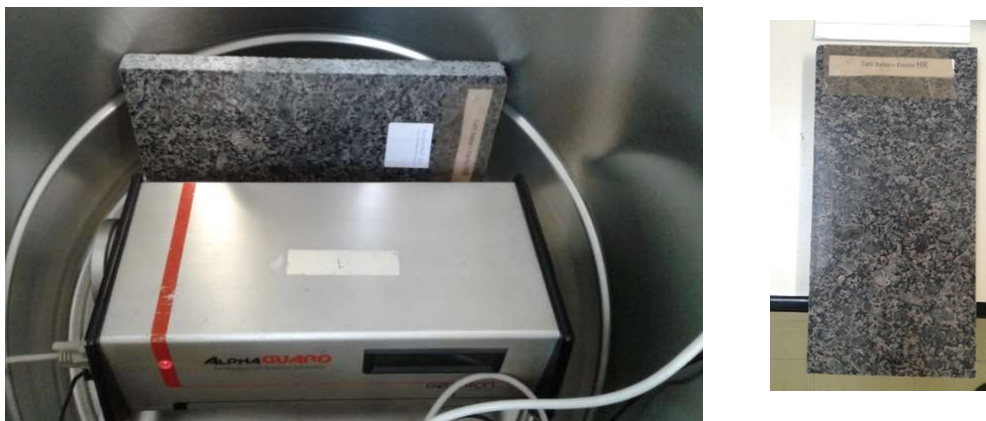
Figura 41: Posicionamento da amostra e do AlphaGUARD no interior da câmara
