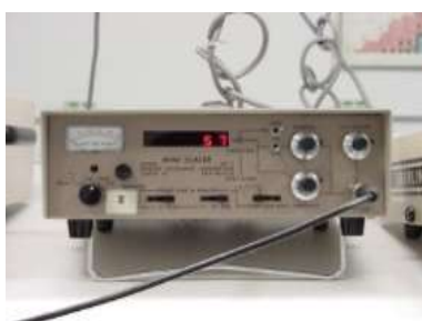
Figura 31: Sistema para determinação alfa total: MS-2 e RD14 e SAC4
