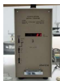
Figura 31: Sistema para determinação alfa total: MS-2 e RD14 e SAC4
