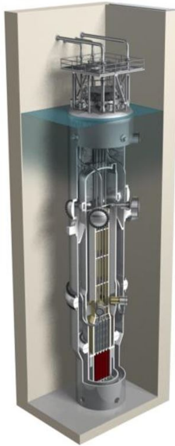
Figura 2.1: Módulo do reator NuScale [1]).
