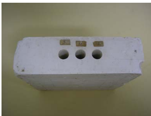
Fig. 4.5 -Vista superior do fantoma com 3 posições de irradiação
