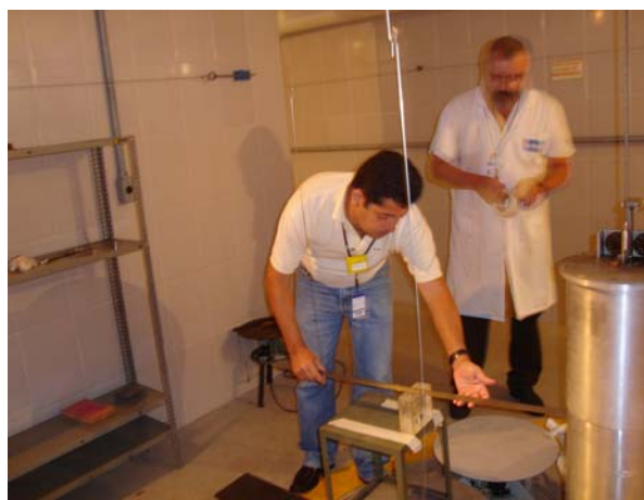
Fig. 4.11 – Posicionamento do fantoma de água no irradiador do CDTN
