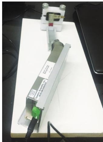
Figura 3.5. Sistema radiográfico para o teste de determinação da CS utilizando o IQI de furo (ASTM E1025).
