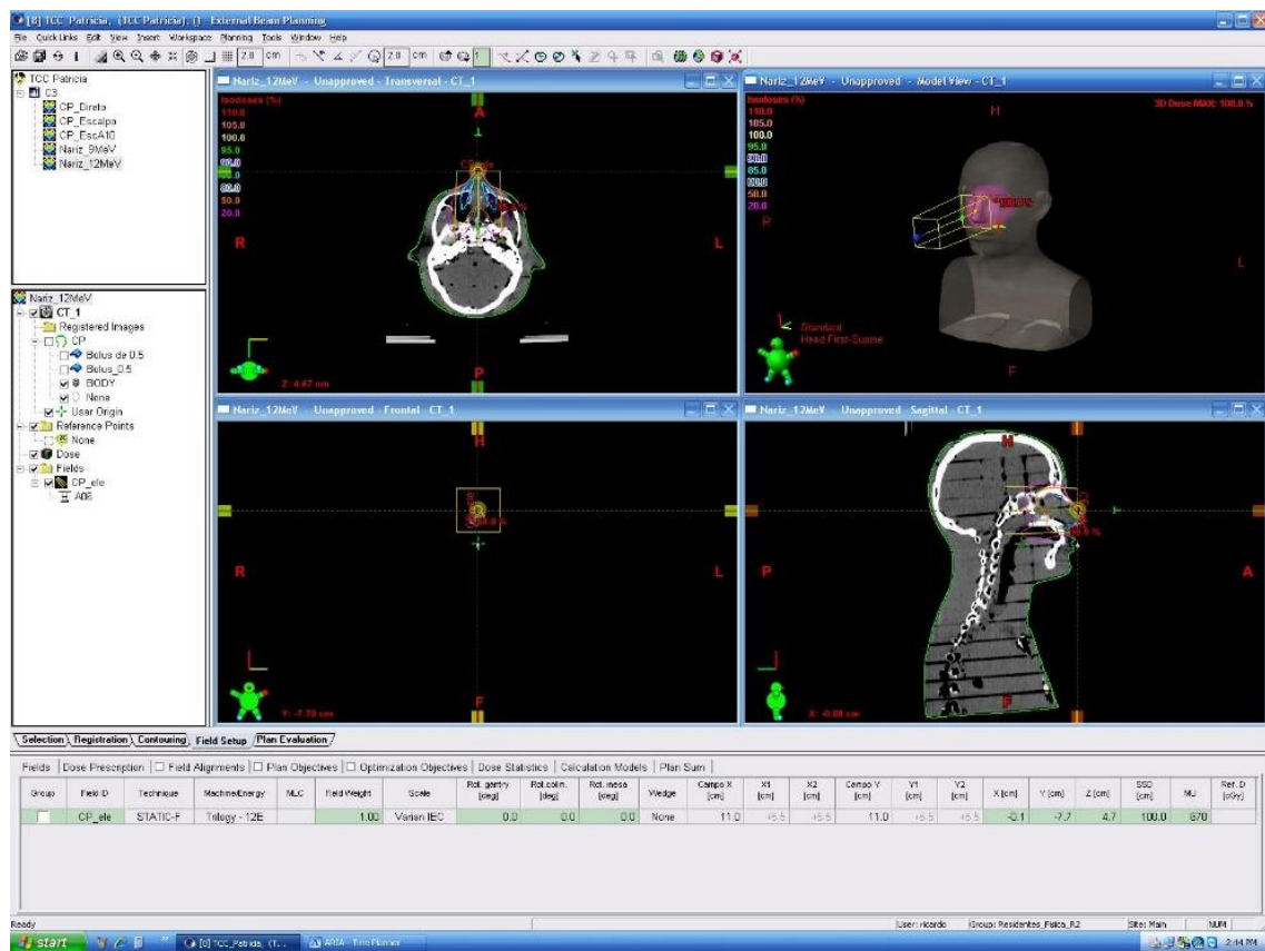
Figura 73: Interface do programa Eclipse™ com visualização axial, frontal, volumétrica, sagital e das curvas de isodose do planejamento para o caso nariz 12 MeV.
