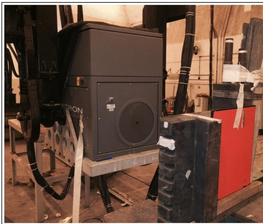
Figura 4.12 – Arranjo experimental com acelerador linear Linatron com 3 MeV de energia – Confab.
