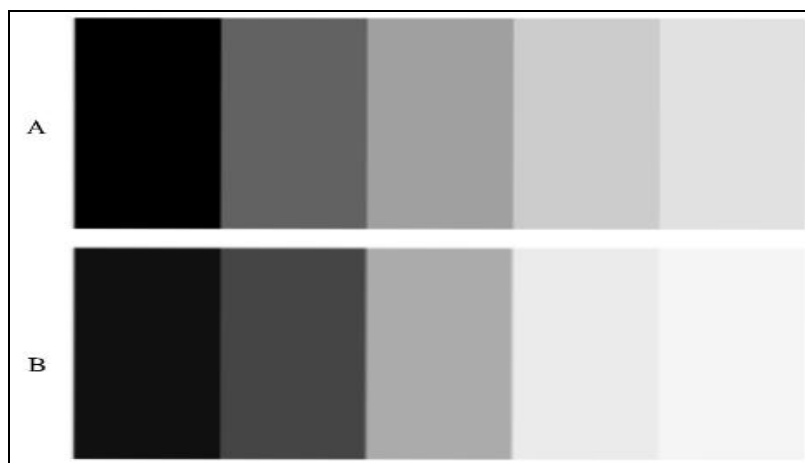
Figura 3.25 – Contraste radiográfico – Exposição (A) 220 kV, (B) 120 kV (SIMÕES, 2012).
