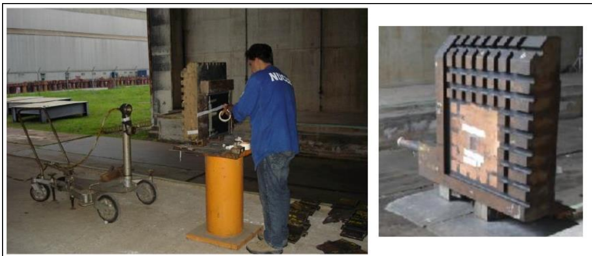
Figura 4.10 – Corpo de prova sendo preparado para ensaio radiográfico – Nuclep.
