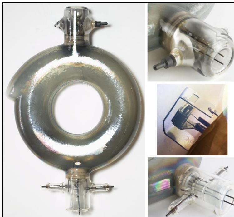
Figura 3.8 – Câmara de aceleração de elétrons de um Betatron de 6 MeV (KERST, 1941).
