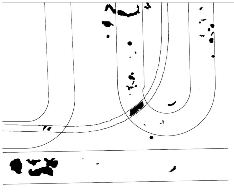
Figura 5.15 – Imagem binarizada obtida com acelerado circular Betatron PXB6 utilizando dois filmes ASTM classe I analisados juntos.
