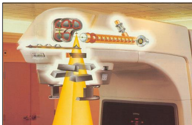
Figura 2.5 – Ilustração de um acelerador durante o processo de teleterapia.
