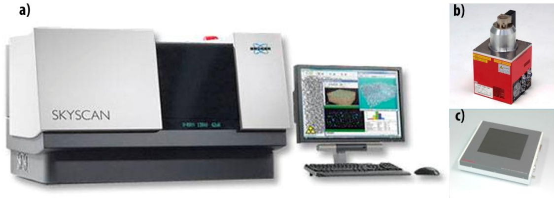
Figura 4. 1: Descrição do sistema A: (a) Microtomógrafo Skyscan 1173 (a); As imagens do tubo de raio X e do detector são apresentadas, respectivamente, nas figuras (b) e (c). Ambos produzidos pelo fabricante Hamammatsu (Iwata, Japão).
