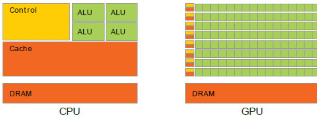
Figura 22 – Projetos diferentes entre CPUs e GPUs
