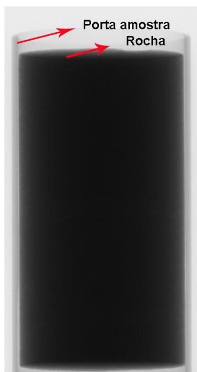
**Figura 4.4:** Imagem de uma projeção de uma rocha carbonática gerada na micro-CT.
