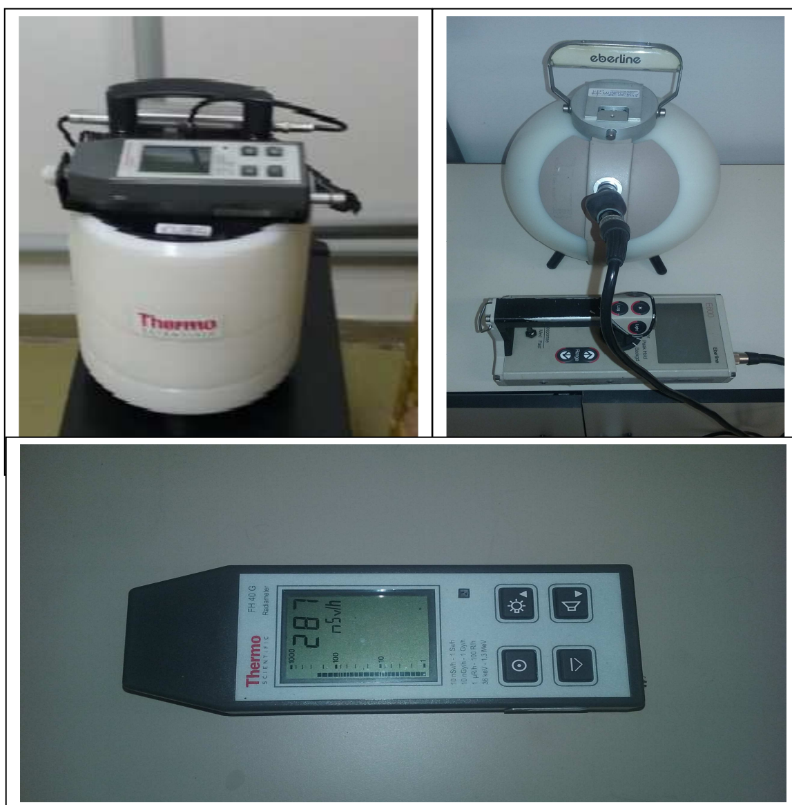
Figura IV.4 - Monitores de nêutrons e gama usados nas medições; WENDI- II (E) , NRD600 (D) e FH40 G-L (abaixo).
