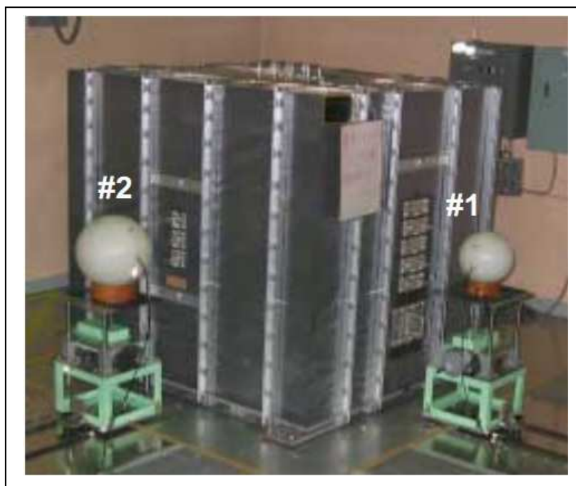
Figura II.4 - Fotografia da pilha de grafite para os campos de calibração de nêutrons térmicos: Existem dois pontos de calibração, # 1 e # 2, na frente de diferentes faces da pilha. (Yoshizawa M.et al, 2004)
