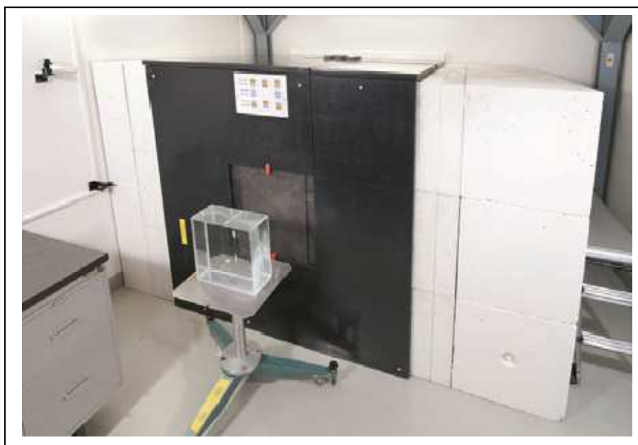
Figura II.7 - Configuração da instalação de nêutrons térmicos do PTB. Em frente à janela de saída do moderador, um fantoma com água é mostrado na posição de referência. (Luszik-Bhadra et al, 2014)
