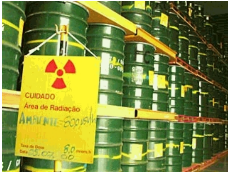
Figura III.1. Disposição dos rejeitos, armazenados no depósito da Usina Nuclear Angra I.
