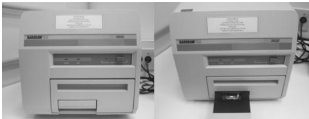
Figura 3.7: Leitora Harshaw 3500 com a gaveta de inserção dos TLDs aberta (detalhe à direita).
