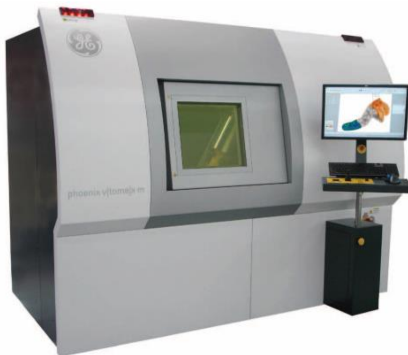
Figura 7- Microtomógrafo Vtomex-m com o painel de controle para manipulação do corpo de prova e o monitor de vídeo (GENERAL ELETRICS SENSING & INSPECTION TECHNOLOGY, 2010b).
