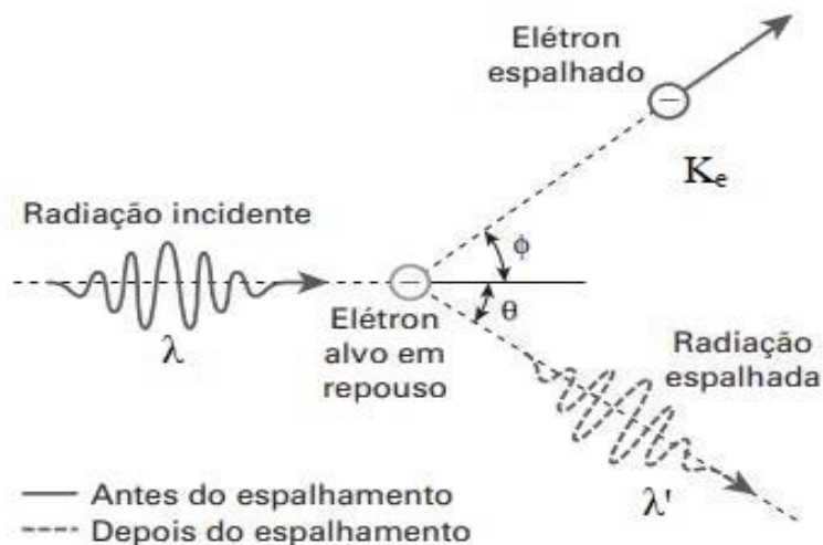
Figura 14: Efeito ou Espalhamento Compton. Fonte < https://pt-static.z-dn.net/files/d45/dbd4fd70478ab55e405a6265793405d7.png >
