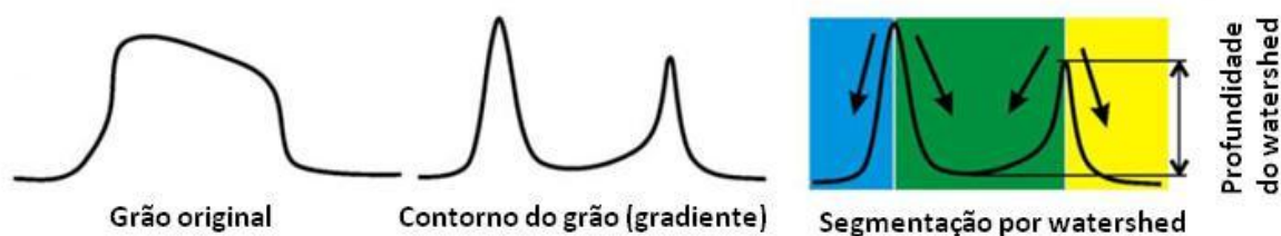
Figura6 - Representação das etapas da segmentação pelo método Watershed . Da esquerda para a direita, a imagem original, no centro a imagem gradiente, e por ultimo, o processo de inundação do método Watershed (BARRAUD, 2006).
