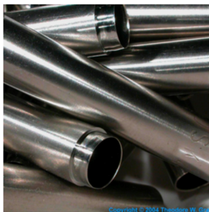
Figura 1.4: Revestimento de uma liga feita de Zircônio de uma vareta combustível tipo PWR [4].
