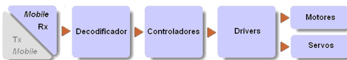
Figura 3.6 Diagrama do sistema de controle operacional
