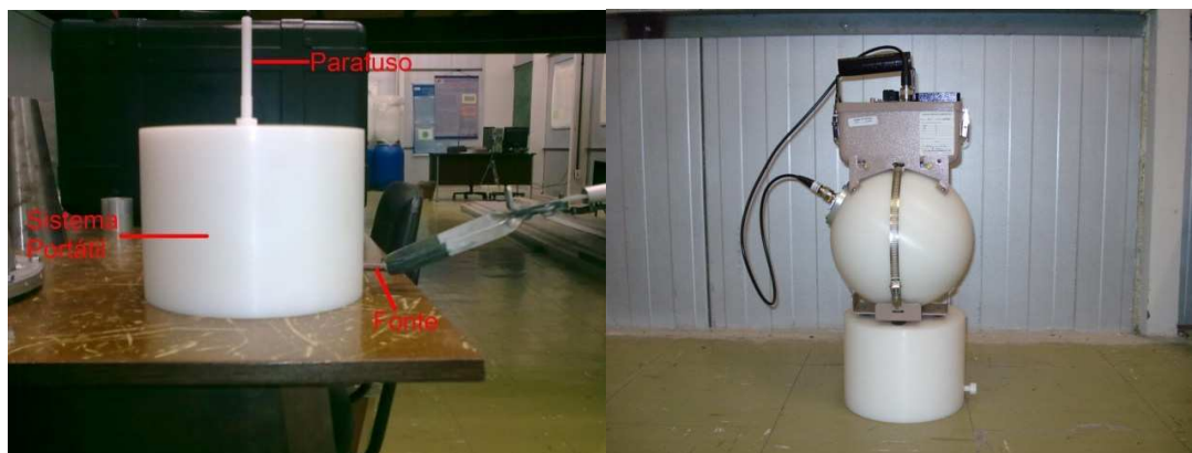
Figura17 – sistema portátil para teste para monitores de área para nêutrons.
