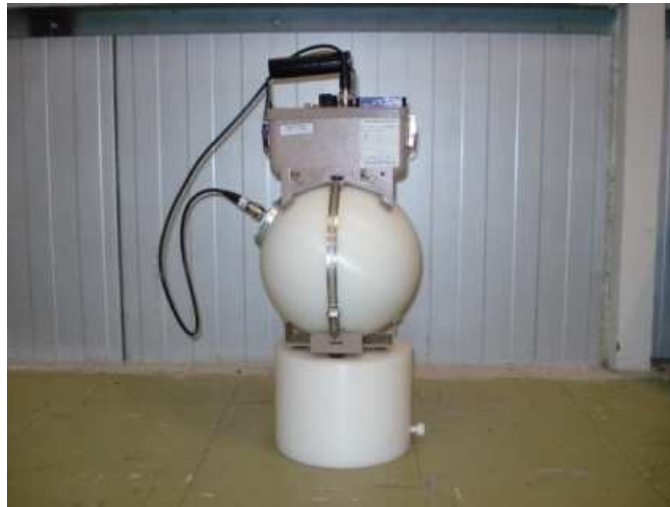
Figura 3 – Sistema portátil com o monitor de área para nêutrons – Ludlum 12-4.
